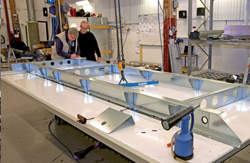
Byske Möblers VD Gösta Marklund, här flankerad av Bercos försäljningschef Lennart Öberg och VD Jim Wallström, är nöjd ägare av en Crafter med VOLYMAX-skåp: "Bilen fungerar bra och det bästa med den är nog skåpet". Berco-skåpen byggs med limmade sandwichelement. Här gifts skåpets "chassi" ihop med golvet (ovan). Benny Holmqvist slutmonterar ett VOLYMIDI-skåp på en Transporter 4MOTION.
