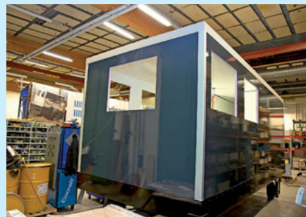
Vid TransportMagasinet s besök hos Berco pågick bygget av ett skåp till en forskningsmodul avsedd för en chilensk Sydpolsexpedition. Ett par månader senare var modulen på plats på Sydpolen, där den har transporterats på släde i sträng kyla, cirka minus 45 grader, men inne i skåpet kunde forskarna avnjuta mer behagliga plus 21-22 grader.
