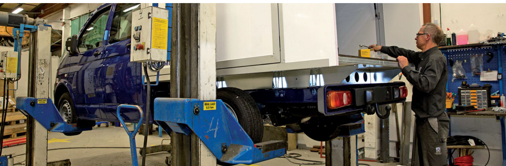
Byske Möblers VD Gösta Marklund, här flankerad av Bercos försäljningschef Lennart Öberg och VD Jim Wallström, är nöjd ägare av en Crafter med VOLYMAX-skåp: "Bilen fungerar bra och det bästa med den är nog skåpet". Berco-skåpen byggs med limmade sandwichelement. Här gifts skåpets "chassi" ihop med golvet (ovan). Benny Holmqvist slutmonterar ett VOLYMIDI-skåp på en Transporter 4MOTION.
